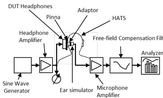
Figure 1. RC8140B-1 Measurement System.<sup>[1]</sup>
